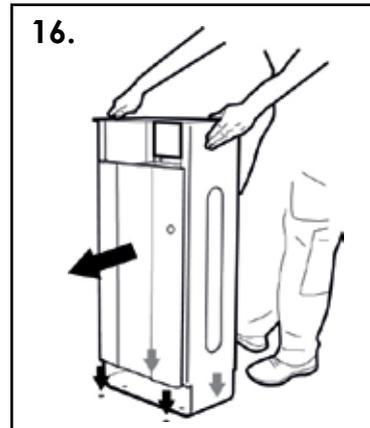
Positionnez le conteneur à l'emplacement défini, alignez bien les orifices situés sur le conteneur avec les trous percés dans le sol.
